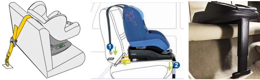
Figuur 5: Bevestigingssysteem KBS met de twee mogelijkheden voor een derde verankeringspunt (© Bébé Confort)
